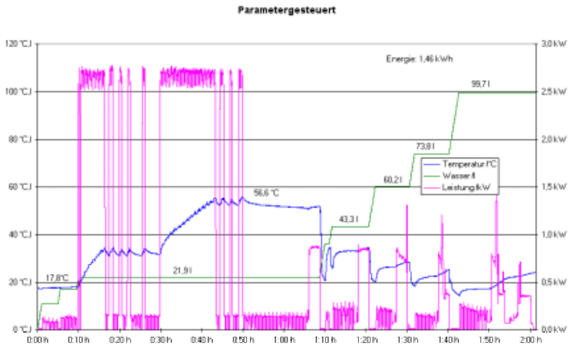
Abbildung 3.4: Parametergesteuerter Programmablauf mit SPS ; Hauptwaschgang 21,9 l
