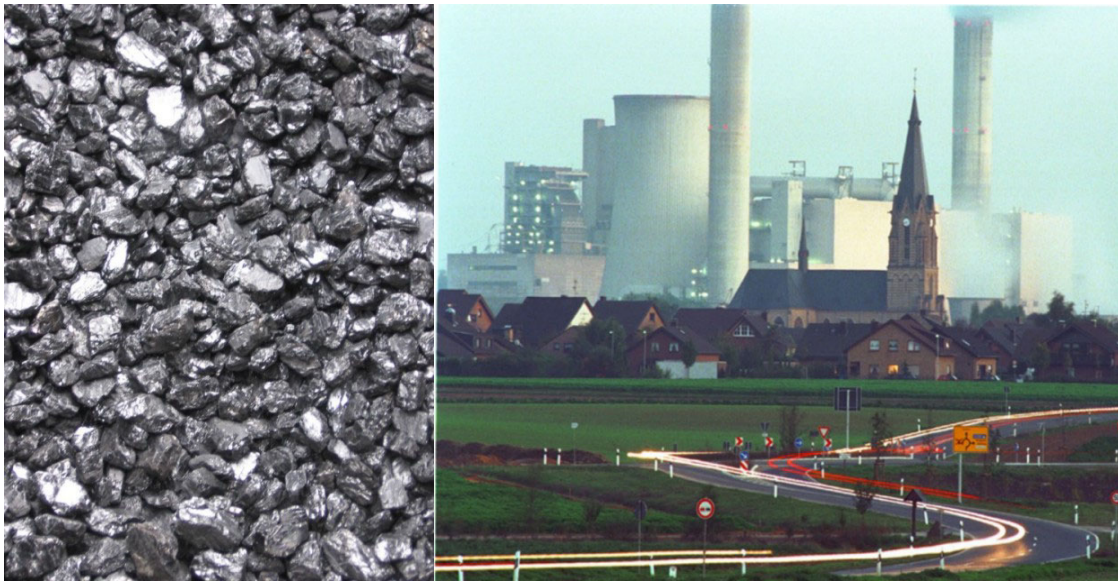
Abbildung 2-7: Das linke Bild zeigt Steinkohle nach der Aufbereitung. So wie sie jetzt ist, kann sie in einem Heizkessel oder einem Kraftwerk (rechtes Bild) verbrannt werden.
