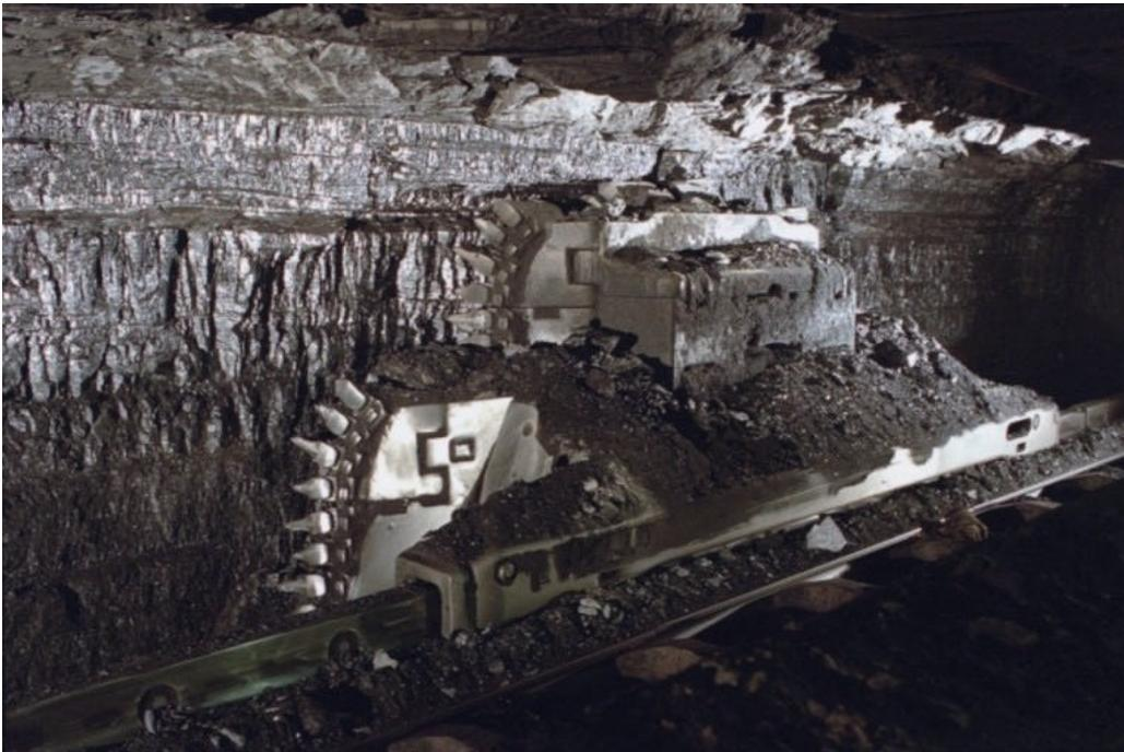
Abbildung 4-2: Das Bild zeigt Steinkohle, die unter Tage im Bergbau abgebaut wird. Die Maschine ist ein Kohlehobel. Er bricht die Kohle aus dem Flöz. Der Flöz ist die Schicht mit der Steinkohle. Steinkohle ist ein nicht-erneuerbarer Energieträger.
