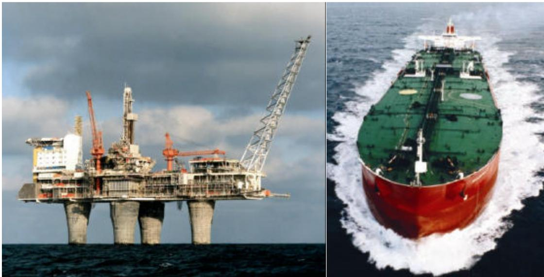
Abbildung 4-12: Das linke Bild zeigt eine Bohrplattform für Erdöl und Erdgas in der Nordsee. Der rechte Ausleger verbrennt an der Spitze Gas. Der Turm in der Mitte ist der Bohrturm. Das rechte Bild zeigt den Öltanker Magdala. Er kann fast 300.000 Tonnen Erdöl fassen.
