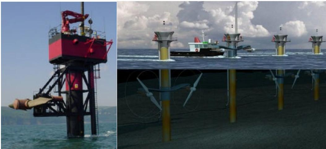
Abbildung 3-12: Die Bilder zeigen Meeresströmungskraftwerke. Das linke Bild ist eine Versuchsanlage. Deutlich ist der Rotor oder Propeller zu sehen. Das Kraftwerk kann abgesenkt werden, wie es auf dem rechten Bild zu sehen ist. Die Meeresströmung dreht den Propeller und über eine Achse wird ein Generator gedreht. Der Generator erzeugt den elektrischen Strom, der mit Leitungen auf das Land geleitet wird.
