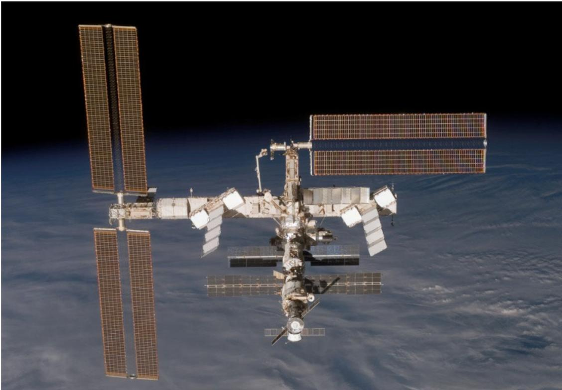
Abbildung 9-2: Das Bild zeigt die internationale Raumstation ISS. Sie schwebt über der Erde. Ganz deutlich sind die Solarzellen zu sehen, die sich nach rechts und links der Raumstation erstrecken. Die Solarzellen erzeugen den elektrischen Strom für die Station.
