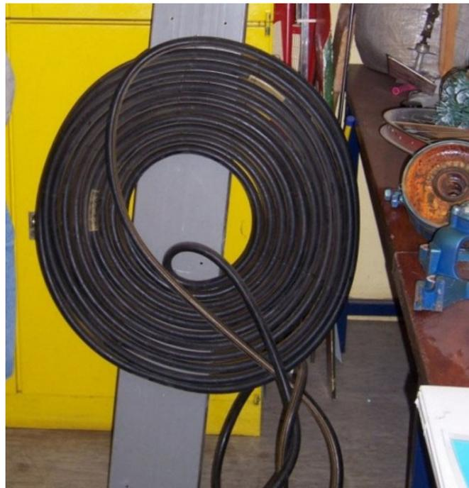
Abbildung 8-5: Das Bild zeigt einen schwarzen Wasserschlauch. Er ist flach aufgerollt, damit er als Schlauchkollektor genutzt werden kann. Der Schlauch wird in die Sonne gelegt und mit Wasser gefüllt. Das Wasser wird sehr schnell warm.
