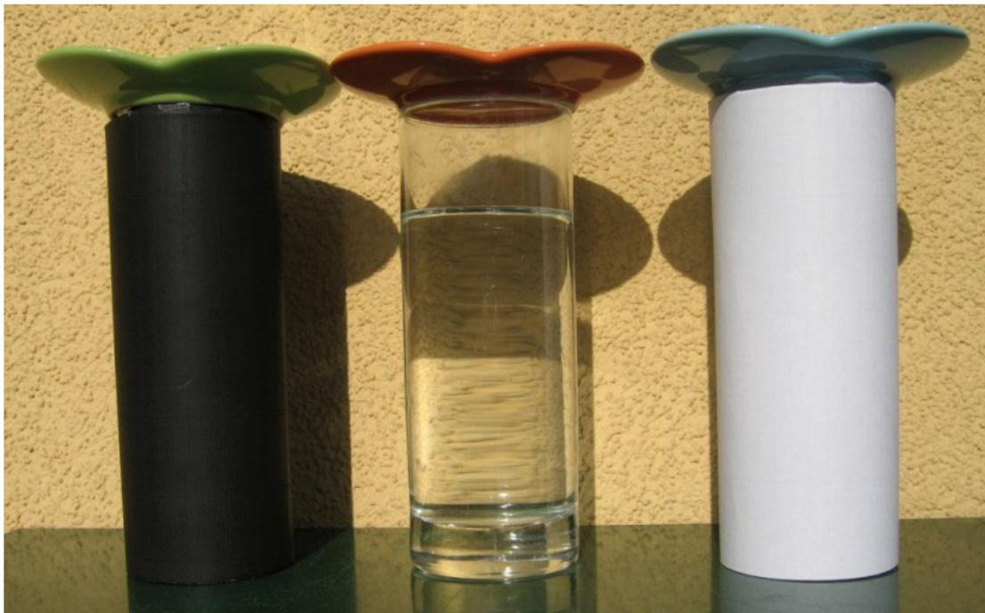
Abbildung 8-2: . Du wirst feststellen, dass das Wasser im schwarzen Glas am wärmsten ist. Dann kommt das Glas mit dem weißen Papier. Das Glas ohne Papier hat das Wasser, welches am wenigsten warm wurde. Dies kommt daher, dass dunkle Dinge mehr Sonnenlicht aufnehmen als helle. Schwarze Dinge absorbieren mehr Licht als weiße. Und durch das Glas ohne Papier geht das Sonnenlicht einfach hindurch. Deswegen braucht es viel länger, um warm zu werden.
