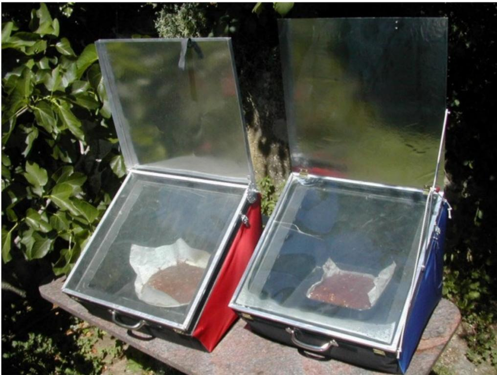
Abbildung 8-4: Das Bild zeigt zwei Solarkocher. In ihnen wird gerade Essen zubereitet. Das Sonnenlicht fällt durch die Glasscheibe und erwärmt die Luft. Die Wärme kann nur ganz langsam aus der Kiste entweichen, da sie mit Schafwolle ausgepolstert ist. Und wenn die Sonne eine Zeit lang in die Kiste scheint, wird die Luft immer wärmer. Und die warme Luft bringt das Essen zum Kochen.
